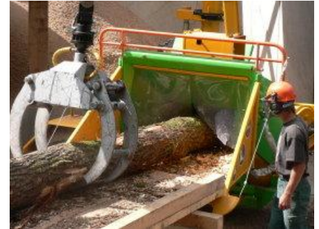
En quelques secondes, le broyeur avale des grumes jusqu'à 40 cm de diamètre.
