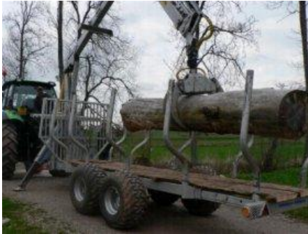
Chargement des grumes grâce à la remorque débusqueuse munie d'un bras articulé.
