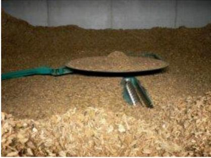
Au fond du silo d'une capacité de 250 m<sup>3</sup>, on voit le dessilleur à pales rotatives et la vis sans fin.
