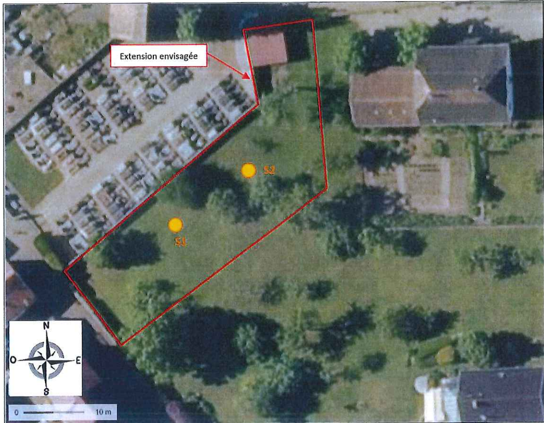
Figure 2 : Localisation des sondages
